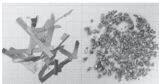
Fig.1 left:ErNiAl foil right:GdNiAl particles
