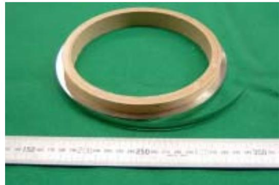
図1 55m長のクラッド配向基板テープの外観
