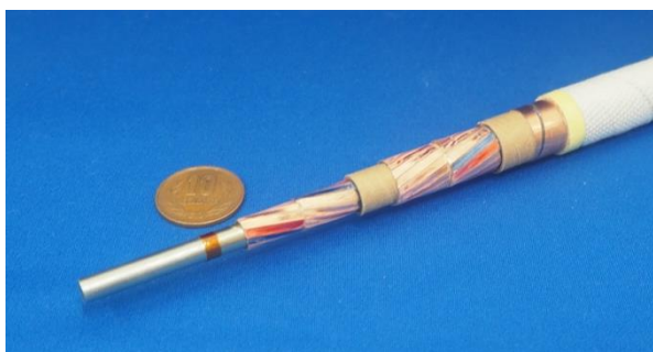
図8 試作した超電導ケーブル（内側）
