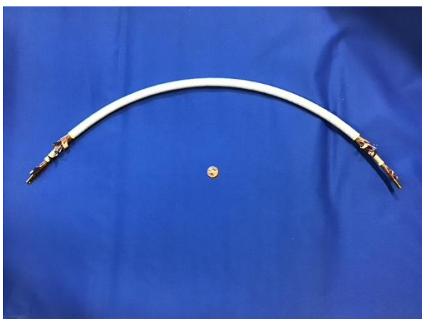
図9 R300で曲げた超電導ケーブル
